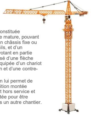
Grue à tour constituée d'éléments de mât, pouvant reposer sur un châssis fixe ou roulant sur rails, et d'un ensemble pivotant en partie haute composé d'une flèche horizontale équipée d'un chariot de distribution et d'une contre-flèche.
