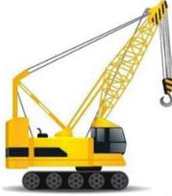
Grue automotrice à flèche treillis qui peut être montée sur un mât (tour), capable de se déplacer en charge ou à vide sans avoir besoin de voie de roulement fixe et qui demeure stable sous l'influence de la gravité.
