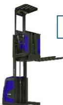
Chariot élévateur gerbeur dont le poste de conduite s'élève avec l'organe porteur de charge à une hauteur de plancher > 1,20 m.
