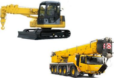
Grue automotrice à flèche télescopique qui peut être montée sur un mât (tour), capable de se déplacer en charge ou à vide sans avoir besoin de voie de roulement fixe et qui demeure stable sous l'influence de la gravité.
